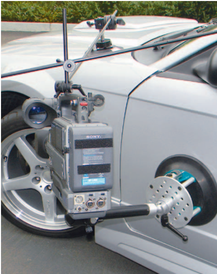
Камера, установленная на автомобиле с помощью системы Car Mount, оснащенной приспособлением Magic Riser
